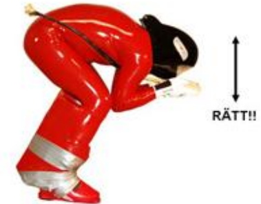
Exempel på rätt flexibilitet i höjlded. Luft tillåts att passera över och under överkroppen.
